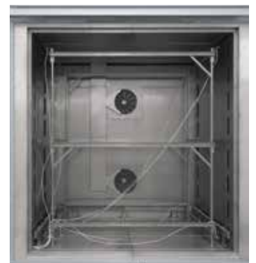
可插入式测试架用于空气循环箱式炉 N 7920/45 HAS 的测试
