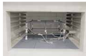
淬火炉内的测量结构
