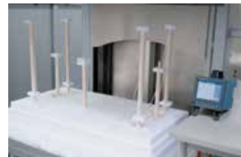
高温炉内的测量结构
