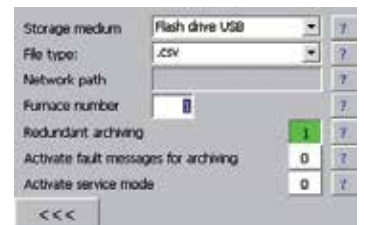
NTLog Basic 用于供纳博热控制器来记录数据
