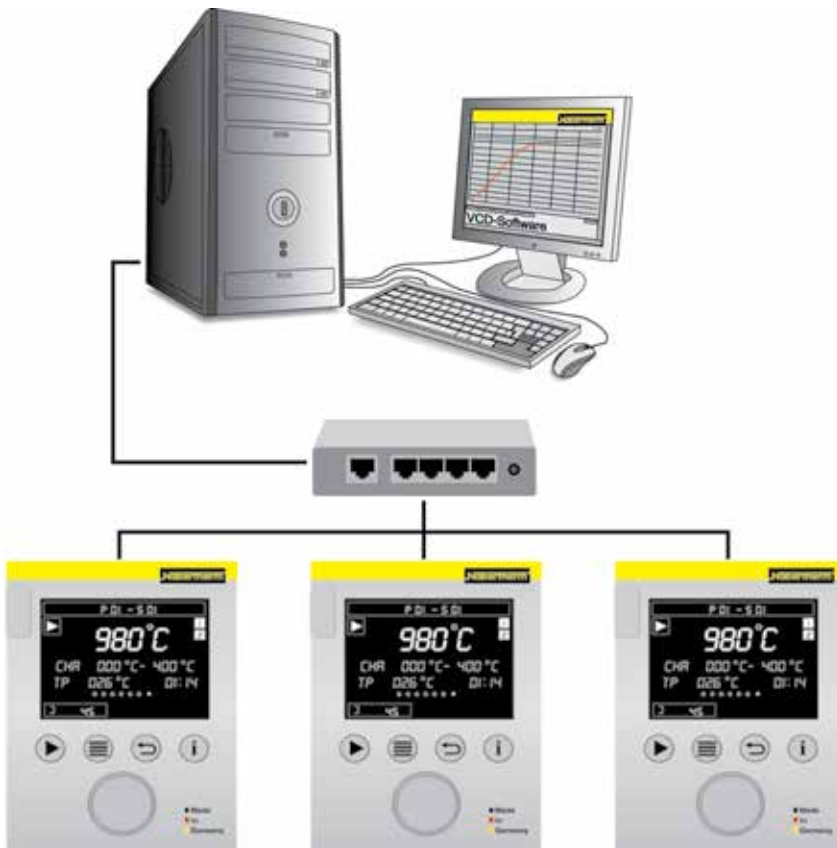
举例说明3台窑炉的配置
