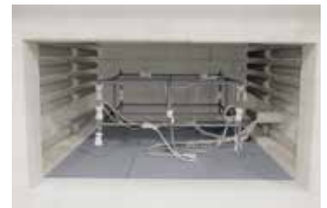
淬火炉内的测量结构
