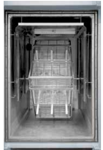
硅树脂回火炉内配有用于装料并被密封焊接的内盒以及旋转底架
