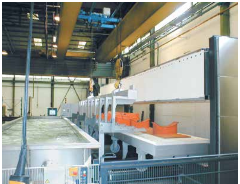
对钢杆件进行淬火的手动调质生产线见第74/75页
