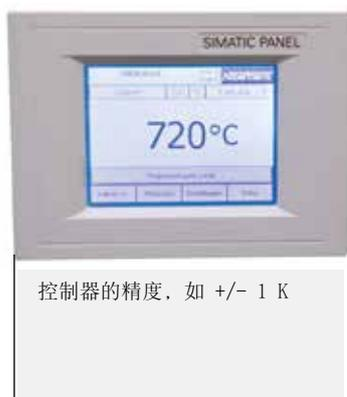
控制器，热电偶和有效加热区的误差总和为系统精度
