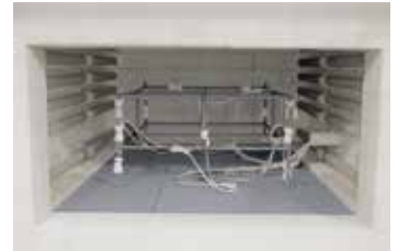
淬火炉内的测量结构
