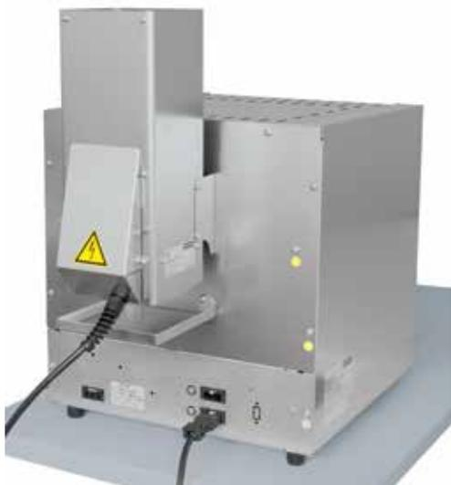
标准实验室马弗炉 L 5/11, 带催化净化器 KAT 50见第12页
