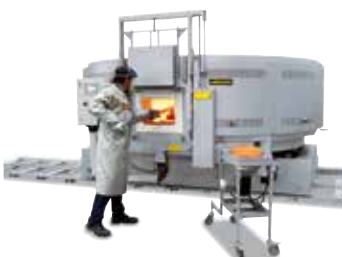
DH 2500/S 型，可在两次锻造加工之间的轨道上移动
