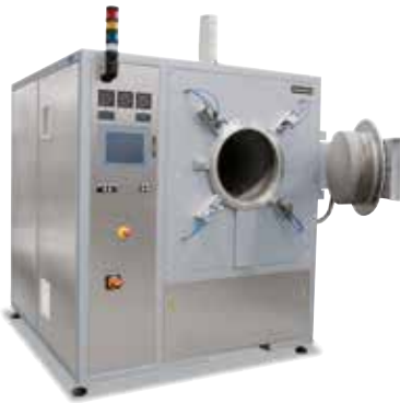
热壁干窑炉，温度可达 1100 °C
