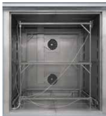
可插入式测试架用于空气循环箱式炉 N 7920/45 HAS 的测试
