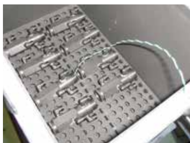
在 VHT 炉内烧结 MIM 钛质零件
